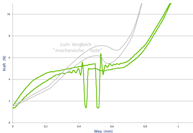
Beispiel eines Kraft-Weg Diagramms : Auslösekraft 4N bei 0,5mm Weg
